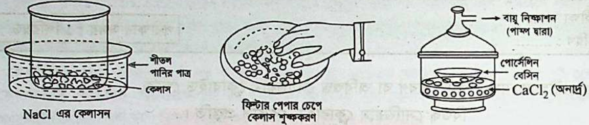
চিত্র-২.২৮ : NaCl-এর কেলাসন, চিত্র-২.২৯ : ফিল্টার পেপার চেপে কেলাস শুষ্ককরণ, চিত্র-২.৩০ : ভেকুয়াম ডেসিকেটরে কেলাস শুষ্ককরণ
